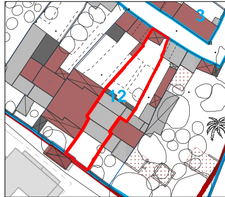
Coperture degli edifici, scala 1:1000
